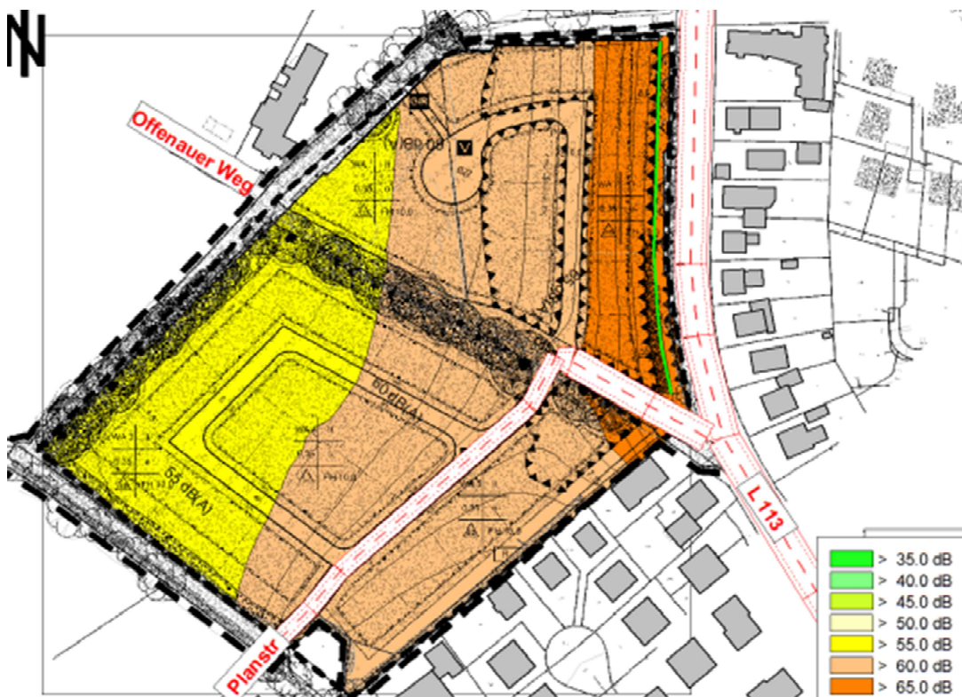
Abb. 1: maßgeblicher Außenlärmpegel für schutzbedürftige Räume
