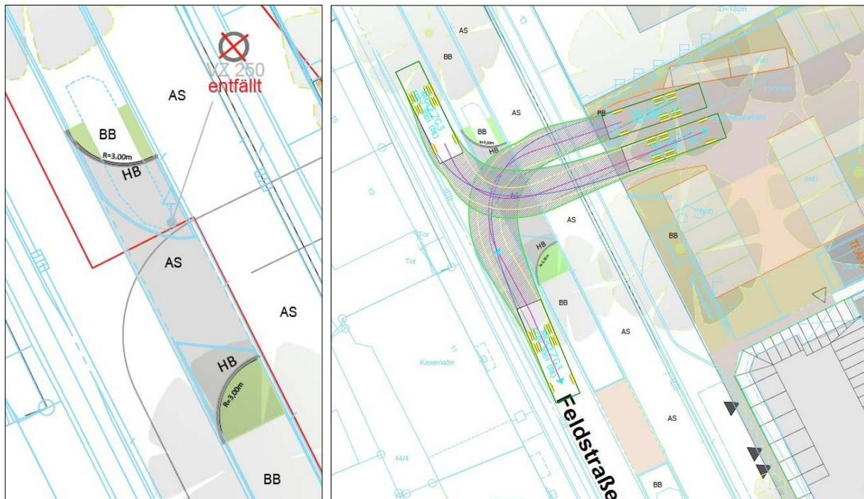
**Abb. 11b** „Schleppkurvenlageplan“ für Müllfahrzeug Grundstücksextern links mit dem Detail zur „Umgestaltung der Mittelinsel“ als Auszug aus der „Verkehrsuntersuchung“ zum B-Plan Nr. 196 (WVK im Juni 2021, ohne Maßstab)
