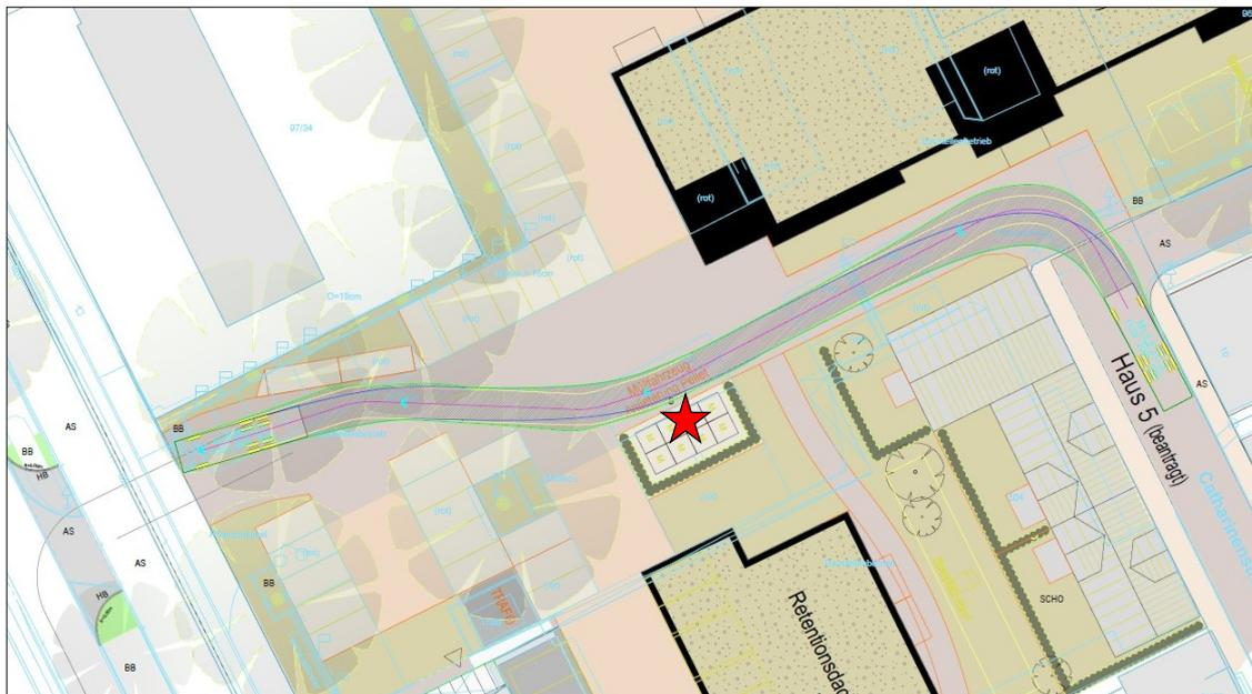
**Abb. 11d** „Schleppkurvenlageplan“ für Müllfahrzeug Grundstücksintern als Auszug aus der „Verkehrsuntersuchung“ zum B-Plan Nr. 196 (WVK im Juni 2021, ohne Maßstab)
